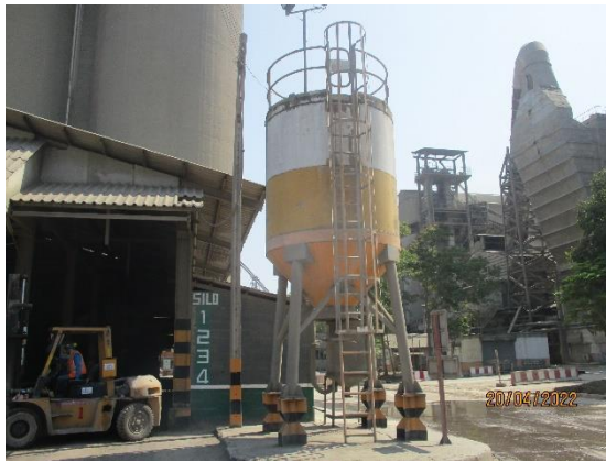
รูปที่ 41 ถังเก็บฝุ่นส่วนเกินเพื่อนำกลับเข้ากระบวนการผลิต
