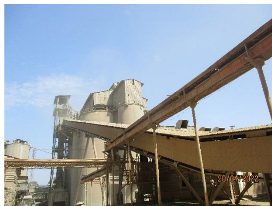
รูปที่ 16 สายพานลำเลียงมีฝาครอบมิดชิด
